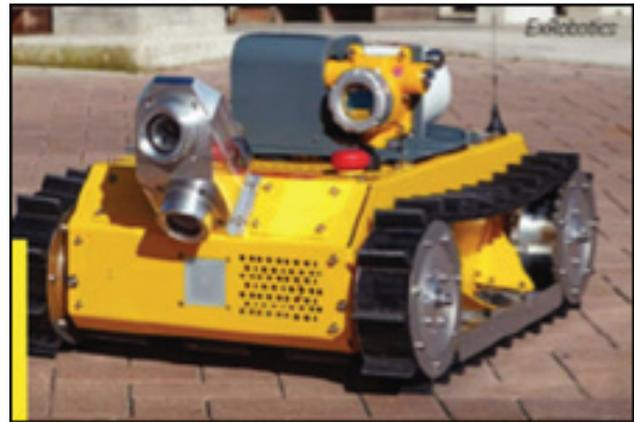
الشكل -1: استخدام الروبوت في عمليات الصيانة بالأماكن الخطرة
