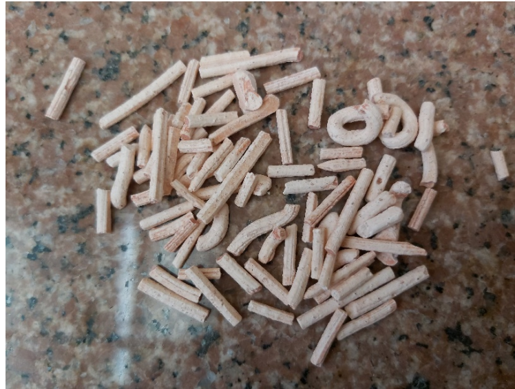
الشكل 17. الوسيط الصلب المكون من أكسيد الفناديوم المحمل على الغضار المشوي.
