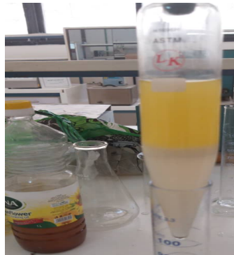
الشكل 12. الديزل الحيوي الناتج من الزيت المستهلك بعد الغسيل
