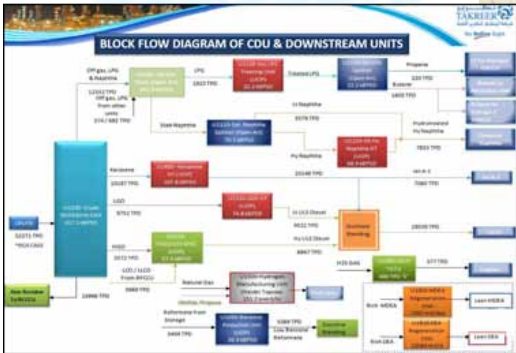
الشكل - 11: مخطط عمليات التكرير في مصفاة الرويس الجديدة
